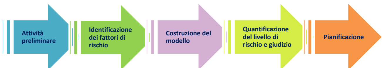
Figura 4. Metodologia generale di analisi dei rischi.
