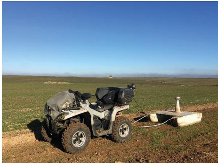
Tecnica della variabilità spaziale del suolo utilizzando la tecnica di induzione elettromagnetica, mediante MiniExplorer GF Instrument.
